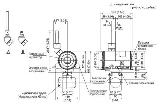
\*1: Когда выбирается код корпуса усилителя 8, это значение равно 307 мм (12,09 дюйма). Когда выбирается код корпуса усилителя 9, это значение равно 187 мм (7,36 дюйма), В обеих случаях рисунки показываются как A и B соответственно
