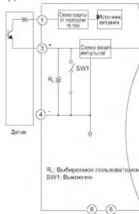
(3) Для приема импульса напряжения при питании датчика от внутреннего источника питания
