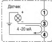
Комбинация с 2-х проводным датчиком с использованием внутреннего источника питания
