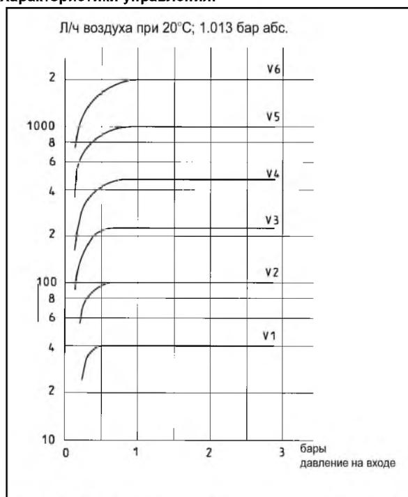
Кривые V1 до V6 показывают зависимость расхода от давления на входе для различных установок клапана. Противодействие на выходе (атмосферное давление) составляет 1 бар.
