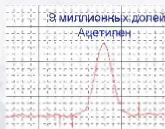
Пример хроматограммы с датчиком теплопроводности
