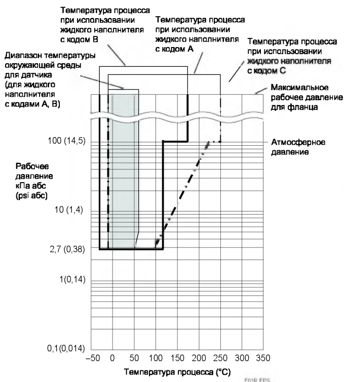
Рисунок 1-1. Рабочее давление и температура процесса (Жидкий наполнитель: силиконовое масло для общего и высокотемпературного применения)
