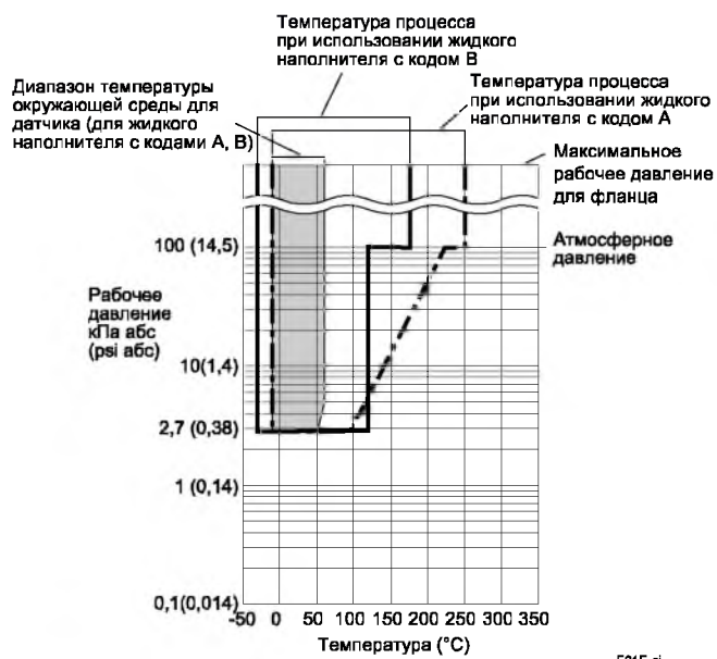
Рис. 1-1. Рабочее давление и температура процесса (Жидкий наполнитель: силиконовое масло для общего применения)
