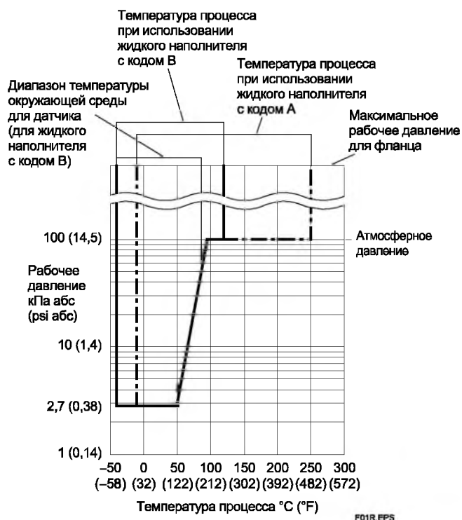
Рис. 1. Рабочее давление и температура процесса (Жидкий наполнитель: силиконовое масло для общего и высокотемпературного применения)
