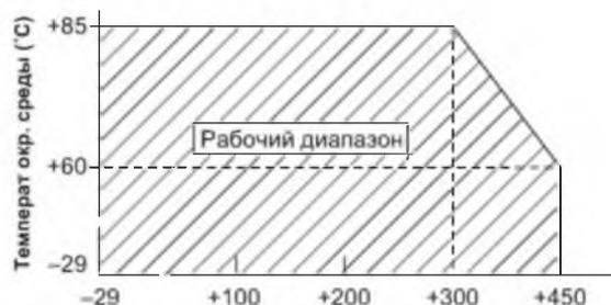
**Рисунок 4. Диапазон температуры среды для высокотемпературной версии**
