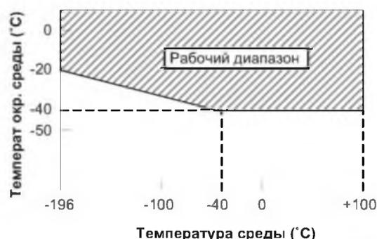
**Рисунок 5. Диапазон температуры среды для криогенной версии**
