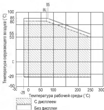
Рисунок 1 Предел температуры окружающего воздуха (интегральный тип)
