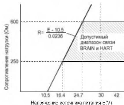
Рисунок 2 Соотношение напряжения питания и сопротивления нагрузки
