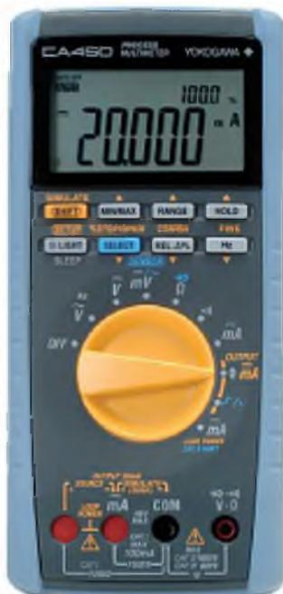
Мультиметр-калибратор для технологических процессов CA450 объединяет в себе функции цифрового мультиметра и генератора токовой петли 4–20 мА.
