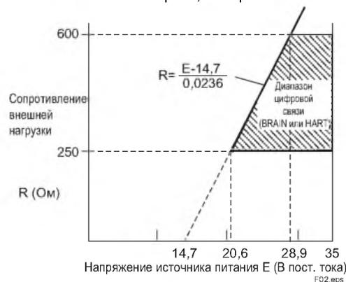
Рисунок 2 Взаимосвязь между напряжением источника питания и сопротивлением внешней
